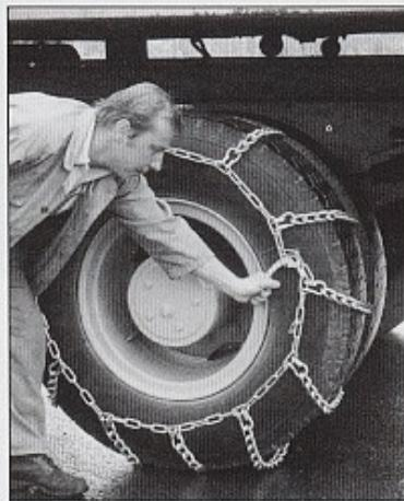
② Na vnější straně navlékneme páku do posledního článku vnějšího bočního řetězu a sklopením pak provedeme napnutí řetězu.
