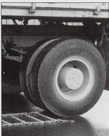
● Sněhový řetěz rozložíme a urovnáme před nebo za kolo vozidla /podle směru najetí/. Napínací páka musí směrovat vně kola, konec řetězu t.j. boční i příčné nesmí být překroucený.
