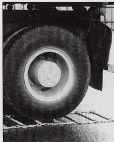
● Delší stranu řetězu přetáhneme přes pneumatiku a urovnáme řetěz na pneumatice.
